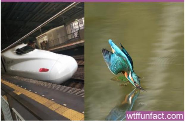
دماغه منحصر به فرد قطار سریع السیر گلوله شینکانسِن ۵۰۰، از وقوع شکست دیوار صوتی هنگام خروج قطار از تونل جلوگیری می کند. این دماغه بر مبنای شکل منقار ماهی خور ک رودخانه ای طراحی شده است، که این شکل منقار به پرنده امکان می دهد هنگام برخورد با آب با سرعت بسیار بالا، سروصدای بسیار اندکی تولید کند.
